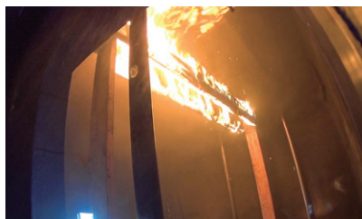
写真2 2×6材の設置状況と燃焼状況
